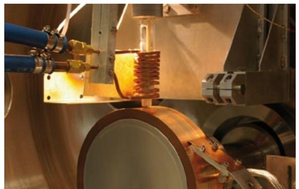
Abb. 1: Melt-Spinning-Anlage zur Erzeugung der metallischen Werkstoffe mit homogenen Eigenschaften.
