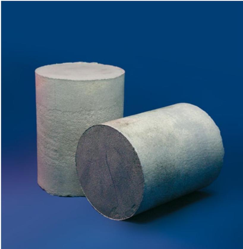
Abb. 2: Mittels SPS kompaktierte Bolzen einer verdüsten Al-Legierung ( $\varnothing$  75 mm, h 85 mm, nahezu 100 % theoretische Dichte).
