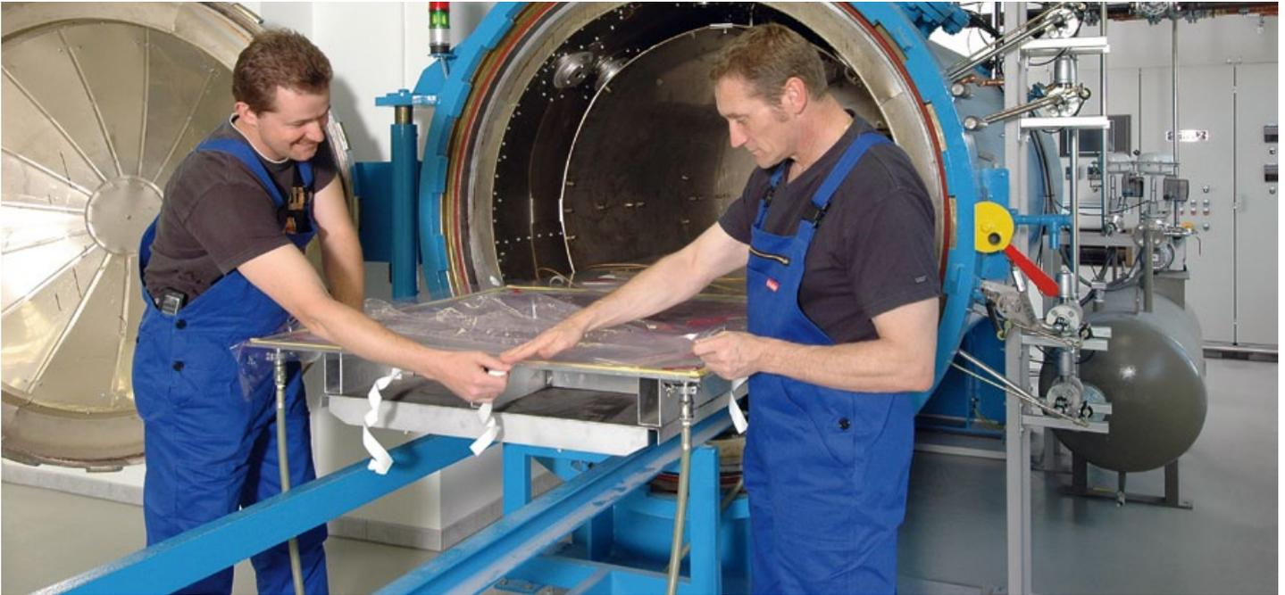
Abb. 3: Autoklav zur Herstellung von Faserverbund-Kunststoffen im Fraunhofer IFAM.
