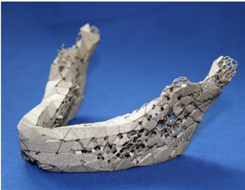
Abb. 5: Mittels SLM hergestellter menschlicher Unterkiefer mit biomimetisch gradierter zellulärer Struktur (metallischer Knochenschwamm).
