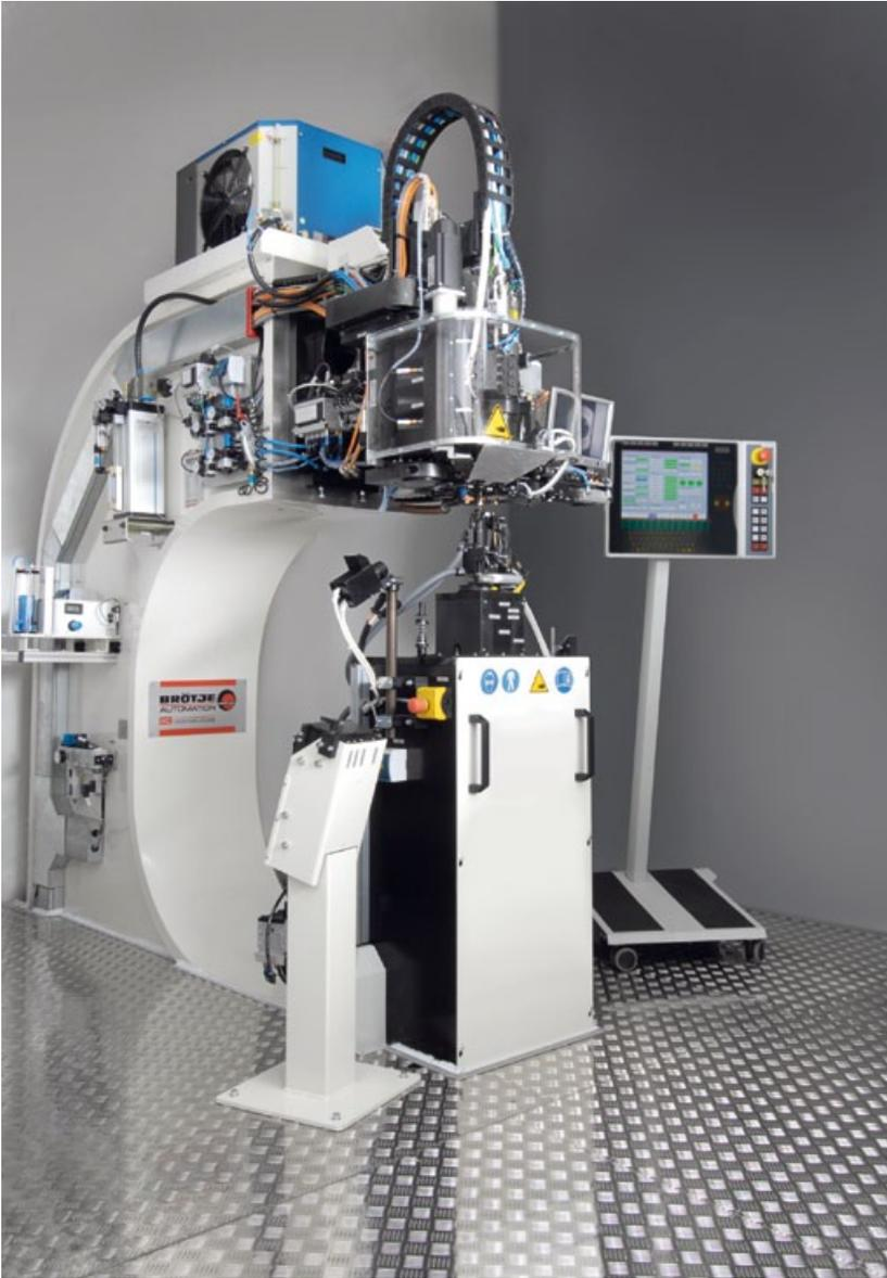
Abb. 2: C-Bügel-Nietautomat des Fraunhofer IFAM.
