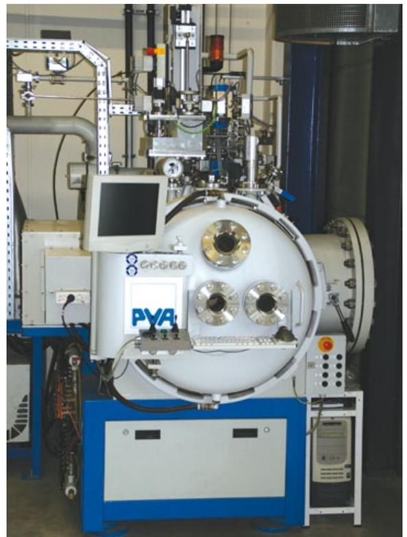
Abb. 2: Schmelzextraktionsanlage.
