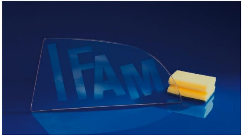
Abb. 2: Transparenter Kratzschutz von Kunststoffoberflächen.
